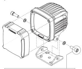
Torque recomendado 37 Nm Torque máximo 48 Nm
