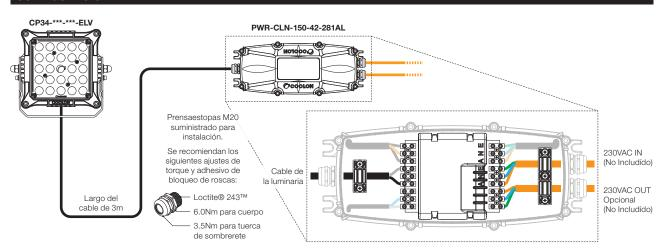
La distancia entre la fuente de alimentación y la luminaria se puede ampliar hasta 15m. La caída de voltaje en el cable no debe exceder 2V. Se debe hacer una conexión de cableado desde el terminal de cableado de entrada al terminal de bucle de salida donde se requiere un bucle de salida opcional.
