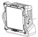
Use Loctite® 243™ compuesto de retención (no incluido) para asegurar la tuerca cúpula
