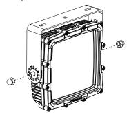
Recomendamos utilizar Loctite® 243™ Compuesto retenedor (no incluido) para asegurar la tuerca ciega.
