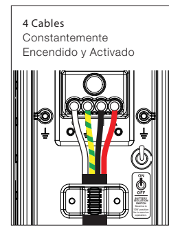
ACTIVADO Uso de luminarias convencionales. con respaldo de emergencia
