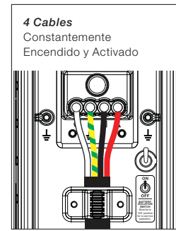
ACTIVADO Uso de luminarias convencionales. con respaldo de emergencia
